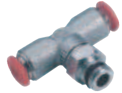
Tee inschroefkoppeling push-in - draaibaar - BSPT male (kort) met draadseal
