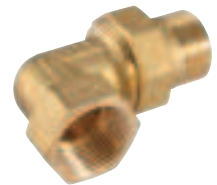
Driedelige kniekoppeling - conisch dichtend - BSP male/female met O-ring
